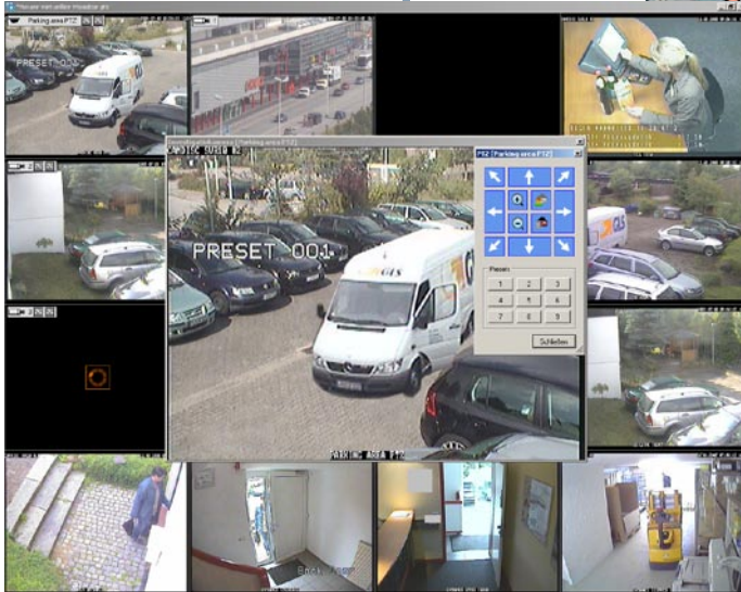
Mit Hilfe des Inverstigativfensters ist eine vergrößerte Darstellung möglich; gegebenenfalls kann auch hier eine Archivauswertung oder PTZ- und Relais-Steuerung genutzt werden.
