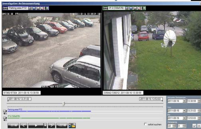
Mit Hilfe der investigativen Archivauswertung ist die zeitsynchrone Wiedergabe und der Export der aufgezeichneten Bild- und Audiodaten von bis zu zwei Kameras gleichzeitig möglich.
