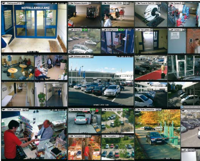
CamControl MV Monitor mit 24-fach Darstellung (Frei definierbare Layouts auf bis zu 4 Monitoren wählbar)
